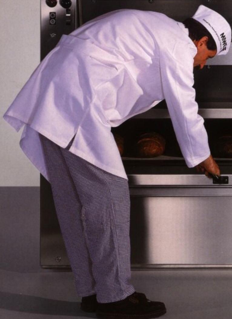
2 okruhová pec MIWE ideal s vytahovací etáží
